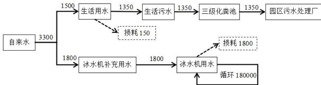
图 1 项目水平衡图 (单位:  $\text{m}^3/\text{a}$ )
