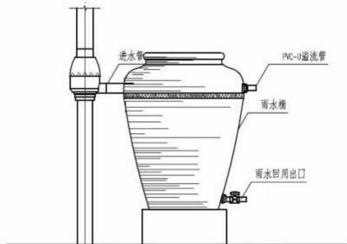
图 3-15 雨水罐典型构造示意图
