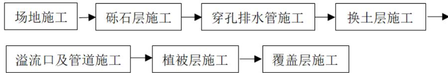
图 3-7 生物滞留设施施工流程图
