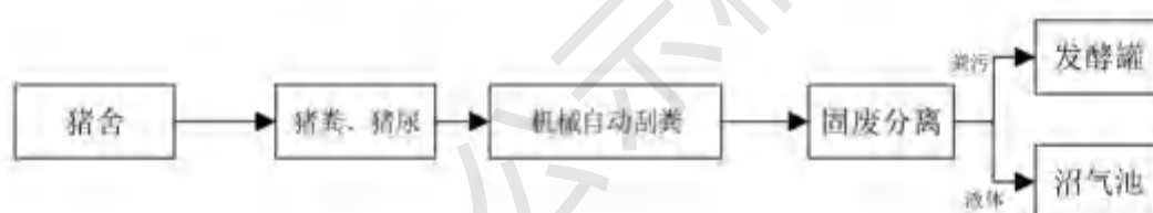
图 3.2.2-2 本项目干清粪工艺示意图
